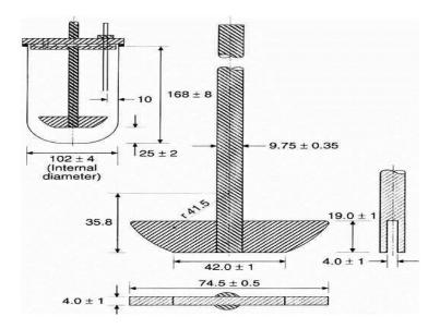
Figure : Dissolution Test Apparatus
