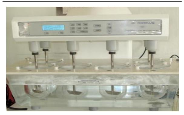
Figure : USP XIII Tablet Dissolution Apparatus II
